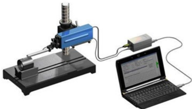
Рис. 1. Приклад високошвидкісного профілометра
